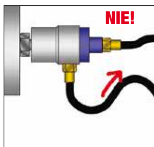
Część przewodu odprowadzającego skierowana w górę
