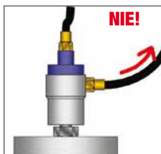
Przewód odprowadzający skierowany do góry
